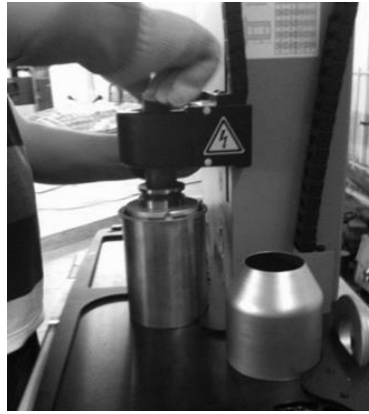
Şekil 3. Kesici takımların sıkı geçme yöntemiyle takım tutucuya yerleştirilmesi
